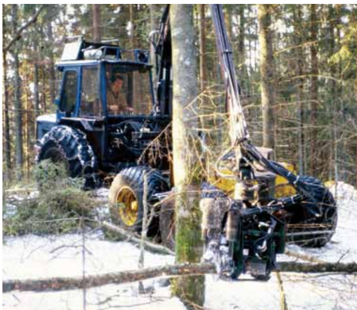
Figur 6 a & b. SP-21 blev det allra första engreppskördaraggregatet i Sverige.
