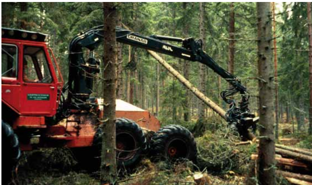
Figur 5. Gripprocessorn RK 450, föregångaren till engreppskördaren.
