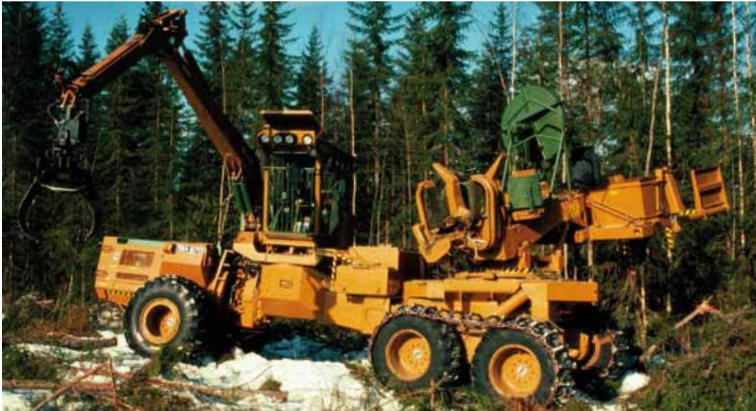
Figur 4 b. Processor som kvistar och kapar virket, även den monterad på en ÖSA 670 basmaskin.
