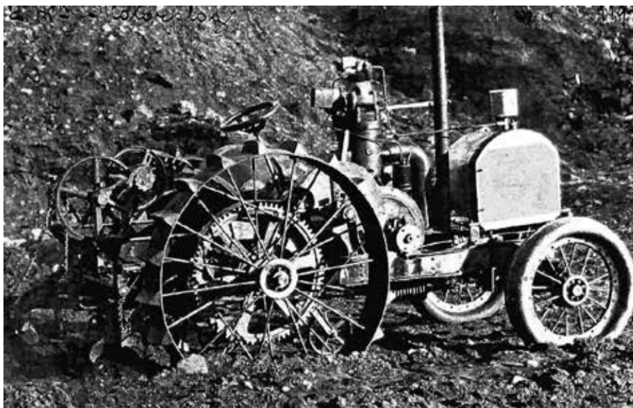
Bild 4:3. Avance motorplog från J.V. Svensons Motorfabrik – ”den första tillverkade april 1912” med 12 hk tändkulemotor. Motorplogen på bilden är en prototyp som skiljer sig från de senare serietillverkade maskinerna, bl.a. på plogarnas lyftanordning. Foto: J.V. Svensons Motorfabriks arkiv, Arkiv Sörmland.
