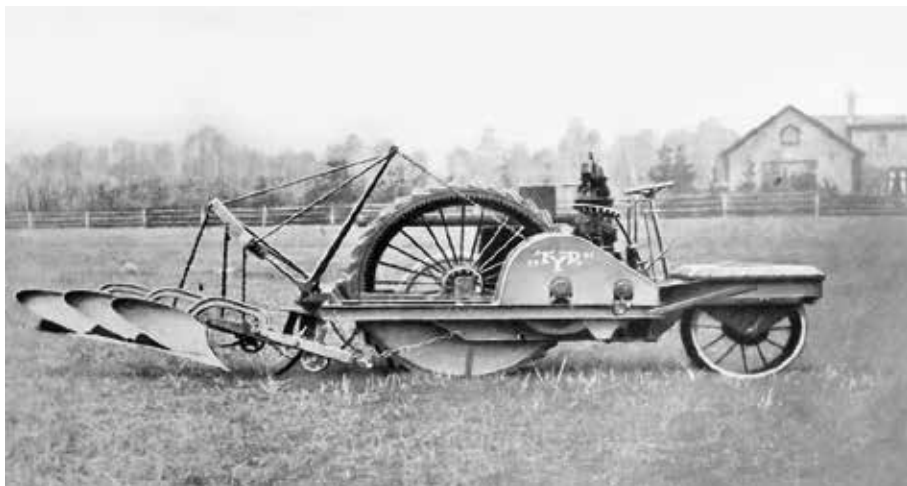
Bild 4:9. Motorplogen Tyr tillverkad av AB Nybro Motorplogar, var försedd med en encylindrig tändkulemotor och endast ett drivhjul. Den trehjuliga konstruktionen gjorde dock maskinen ostadig och den välte vid provningarna i Alnarp. Källa: SMP 1920 medd. 60.
