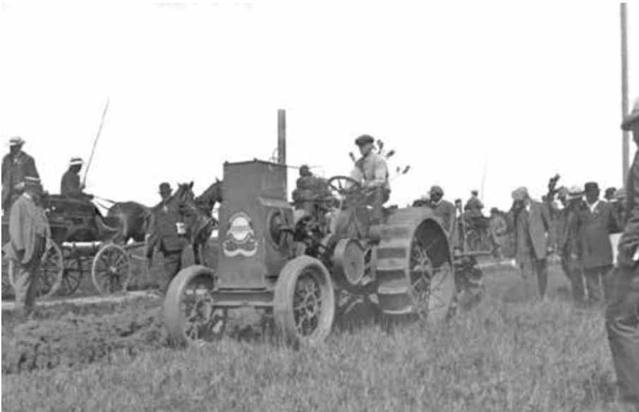
Bild 5:1. Den första serietillverkade versionen av Avance motorplog under demonstrationsplöjning på Ultuna 1913. Foto i SMP:s arkiv.
