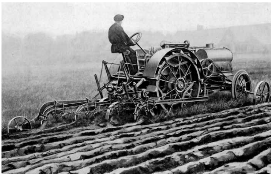
Bild 4:5. Malcus motorplog tillverkad av Svenska Motorplogfabriken i Halmstad, var en av de tyngre svenska motorplogarna och försedd med en fyra- eller sexcylindrig förgasarmotor. Högra hjulen går ”på land” och motorplogen är därför försedd med s.k. styrpilot för att underlätta plöjningen.
