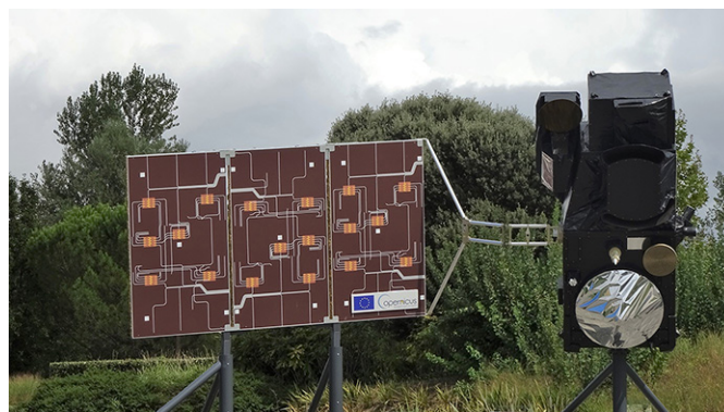
EU har investerat stort i Copernicusprogrammet, men flera talare ansåg att EU fäster för stor tilltro till satellitdata. Prototyp av fotovoltaikpanel för Sentinel-satellit, Copernicusprogrammet. Foto: Celeda [CC BY-SA 4.0].
