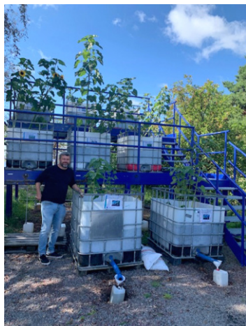
Frank Schmieder vid odlingsbäddar som används för att följa effekterna av olika inblandning av botten sediment, strandvallsmaterial och biokol vid Malmfjärden i Kalmar. Foto: William Hogland.
