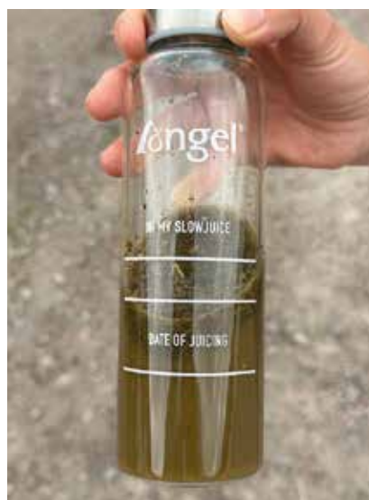
Pressjuice kallas, om den kommer från färsk vall, också grönjuice efter passage genom skruvpressen. Fiberresterna på ytan silas bort i ett filter innan juicen värms upp så att proteinerna koagulerar.
