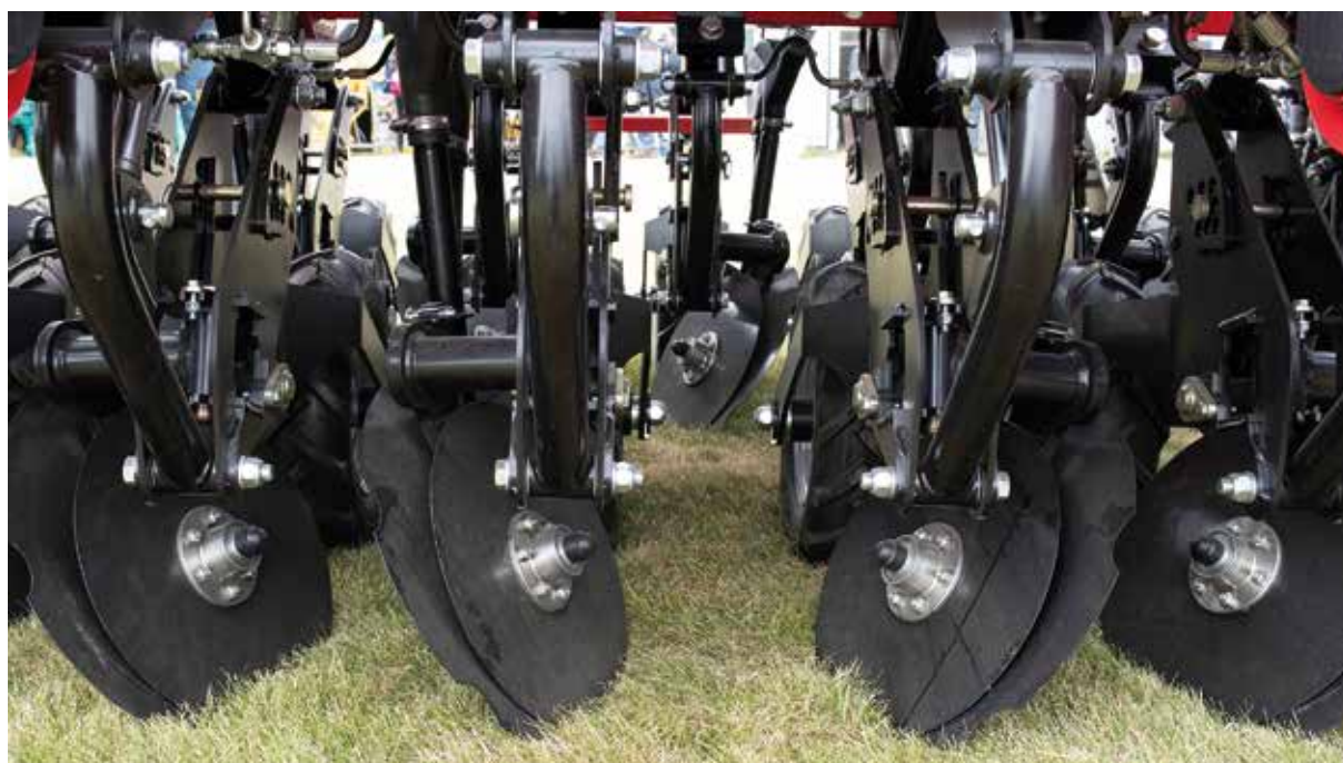
Brittiska Weaving har extremt snedställda tallrikar för att skapa en flik i vilken fröet placeras innan fliken återpackas. Foto: Agtech Sweden.
