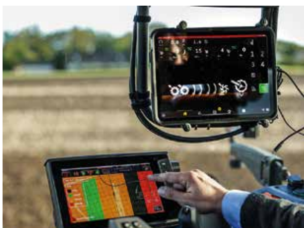
Väderstads kultivator TopDown med E-services används i en studie där kultivatorns inställning anpassas till fältets egenskaper med jordartskartan som stöd. I försöket testas olika inställningar av TopDowns arbetszoner under olika markförhållanden. Bilder: Väderstad AB.
