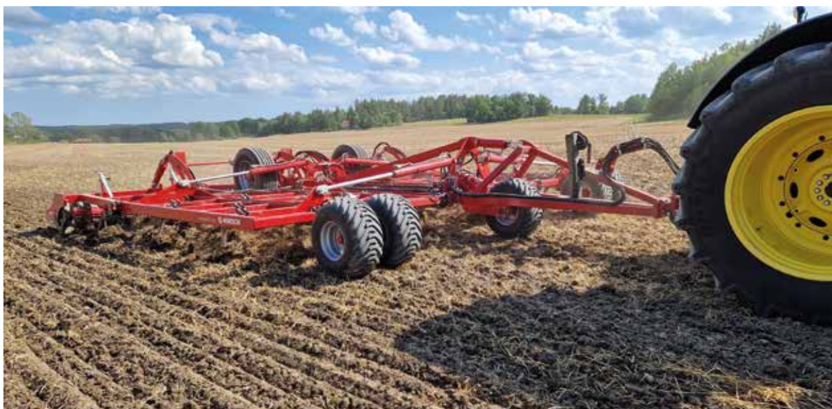
En av delarna i den minimalistiska maskinparken: Ett kultivatorekipage, JD8R370 med en Horsch Cruiser 7XL. Foto: Sture Gustavsson.
