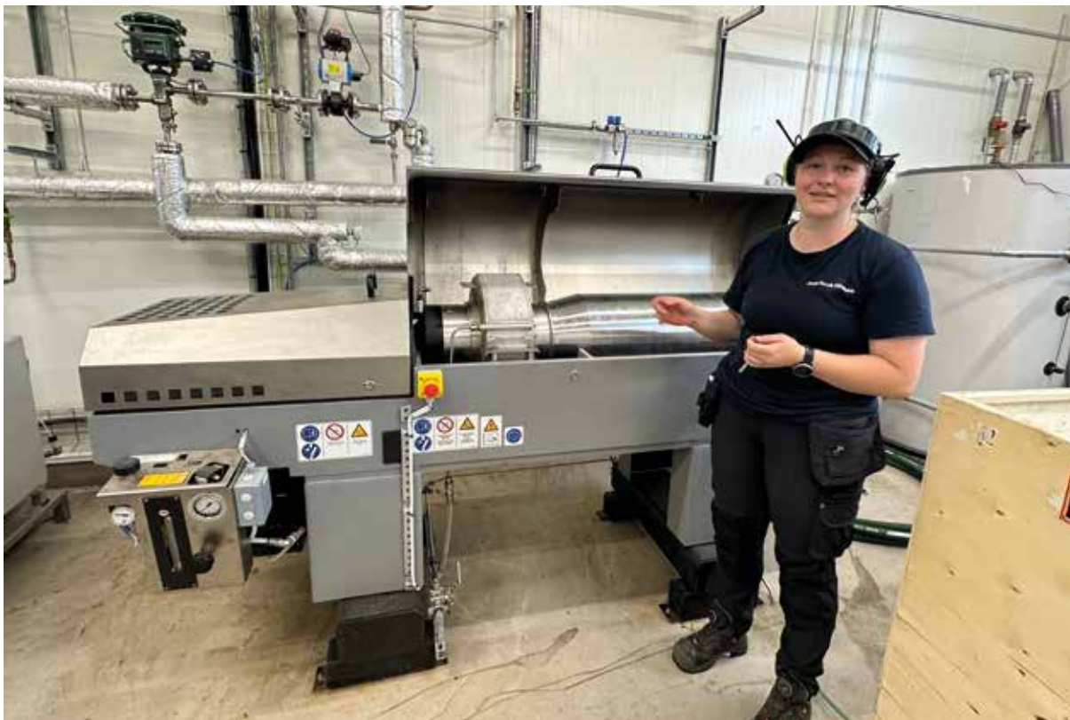
Jenny Hermansson, driftansvarig på Sötåsens skolfjordbruk och bioraffinaderi, framför dekantercentrifugen där proteinet från vallen separeras fram efter uppvärmning så att proteinet koagulerar.
